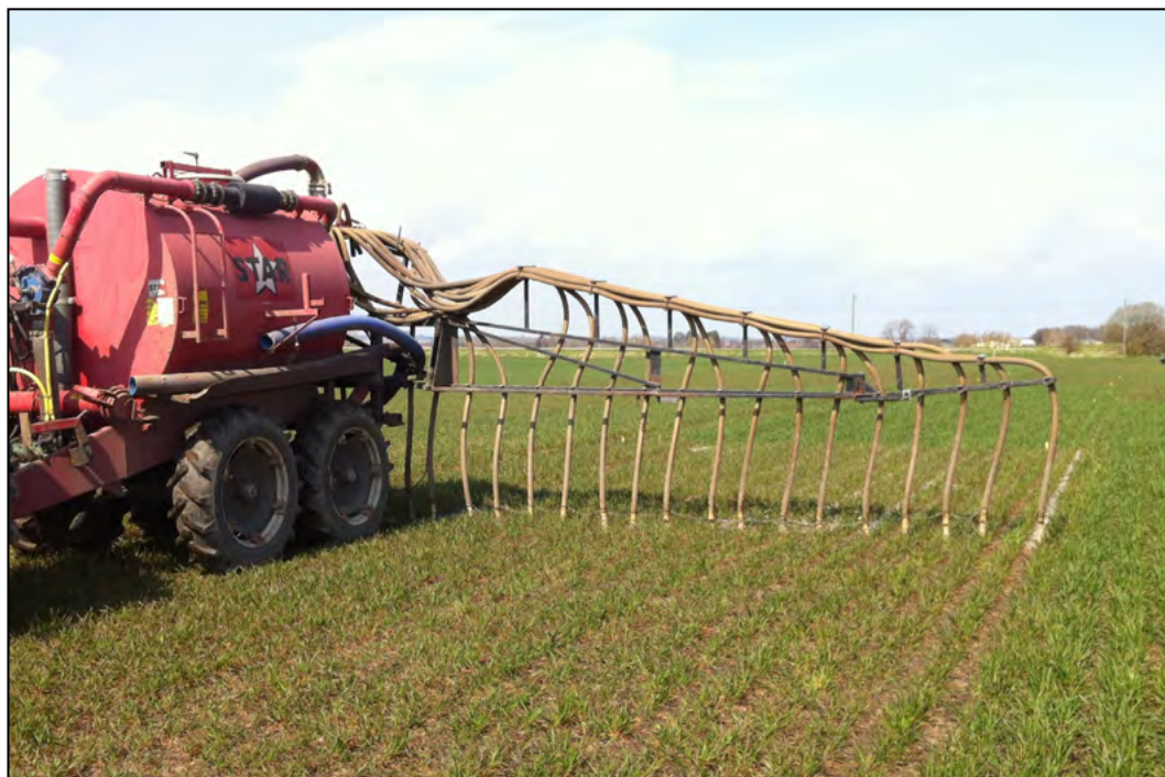
Spridning av svinflyt vid andra tidpunkten till försöket på Österlen. Svinflyten sprids med släpslang av vår speciella försökstunna.
